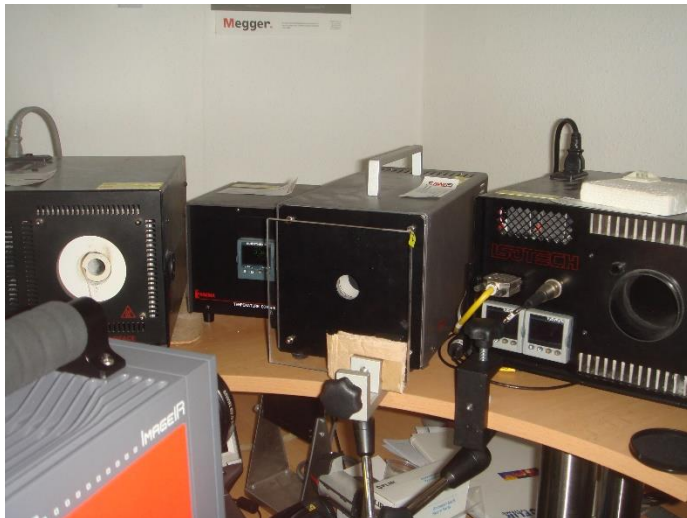
obr. 1 IR okno umístěné kolmo
