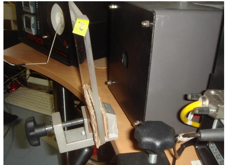
obr. 2 IR okno umístěné s odklonem cca 5^\circ
