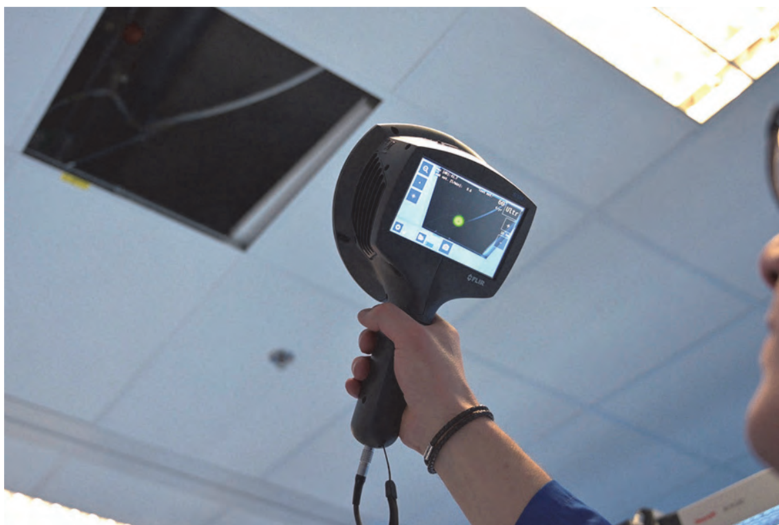
Obr.6 Akustická kamera FLIR Si124 FLIR při kontrole rozvodů stl. vzduchu [1]
