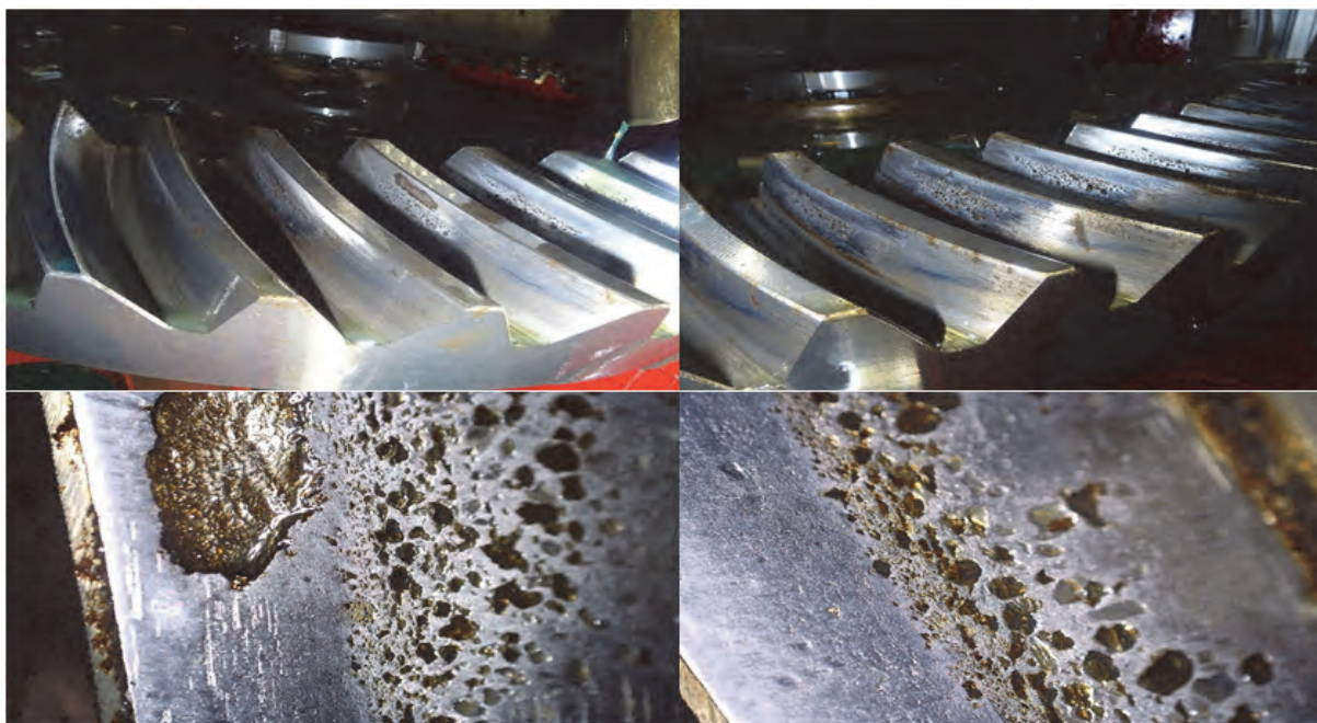
Obr.5 Poškození talířového kola - makrofotografie.
