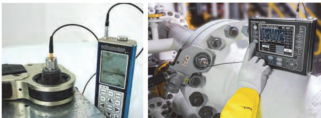
Obr.6 Přístroje pro ultrazvukové měření prodloužení šroubů (Zdroj: [6], [7])
