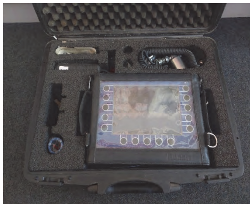
Obr.3 Vibrodiagnostický prístroj ADASH VA4Pro a snímač vibrácií A104-1A
