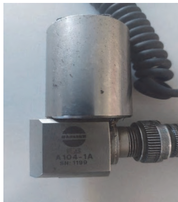
Obr.3 Vibrodiagnostický prístroj ADASH VA4Pro a snímač vibrácií A104-1A
