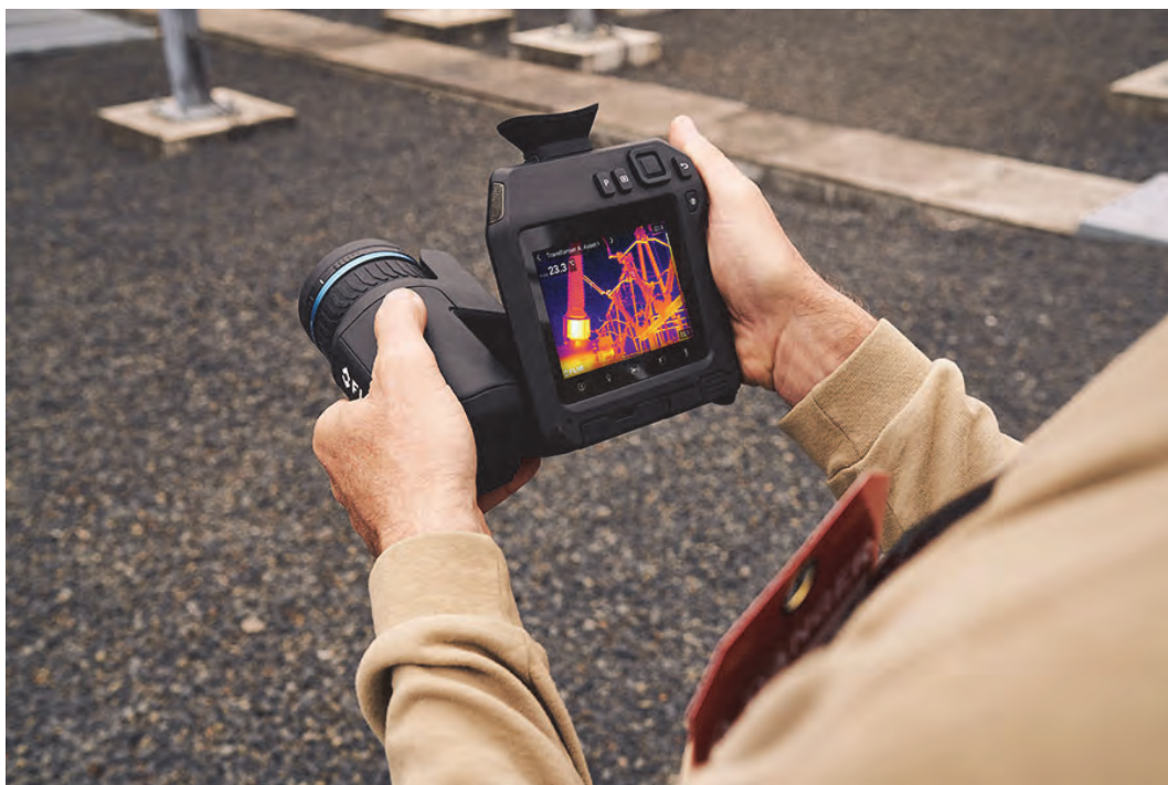
Obr.4 Přenosná termokamera FLIR T865 při kontrole v rozvodně [1]
