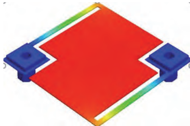
Obr.3 Tepelné rozložení mikrobolometrického detektoru [2]
