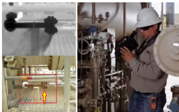
Obrázek 8: Ukázka vizualizace úniku plynu termokamerou FLIR
