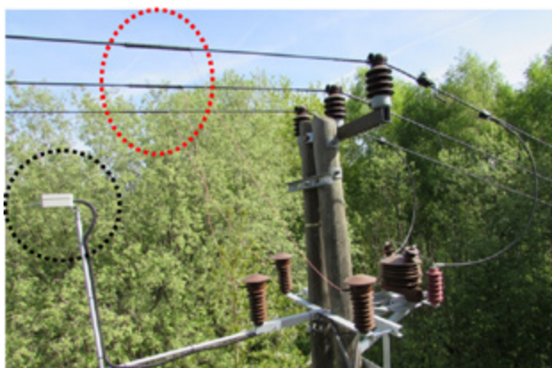
Obrázek 4: Platforma s kontaktními (červeně) i bezkontaktními (černě) senzory
