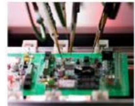
Obrázek 9 – příklad použití mikroskopického objektivu s prodlouženou pracovní vzdáleností
