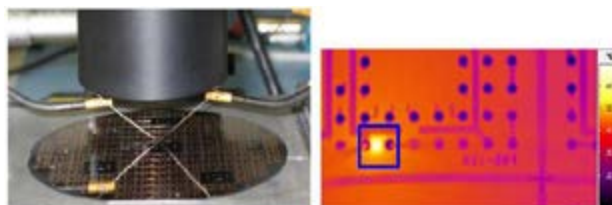
Obrázek 14 – NiCr rezistory na wafer, objektiv Mx3, detector 640×515 px, zorné pole zúženo
