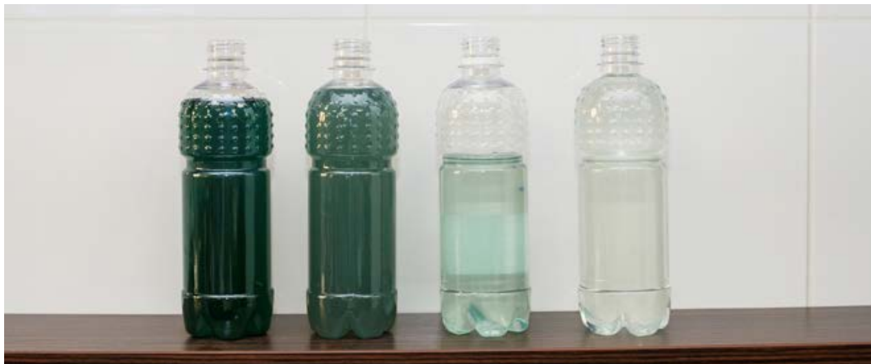
Obrázek 5: Odpad po filtraci, koagulaci, aktivním uhlí a elektrodialýze.
