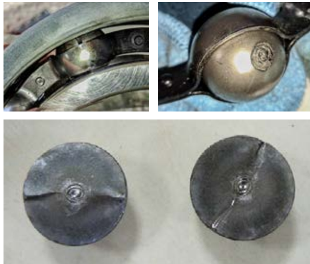
Obr. 12. Poškození ložiska (prasklý valivý element, vady na valivých elementech)
