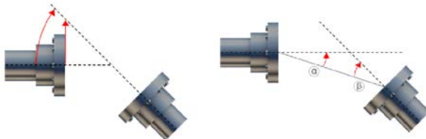
Obrázek 2: Krátká pružná spojka, Úhel a radiál Obrázek 3: Vložená hřídel, Úhly \alpha a \beta
